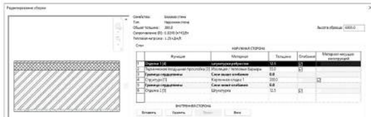
Рисунок 80 – Пример состава наружной стены
