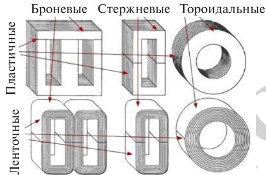
Рис. 2.1. Виды магнитопроводов (сердечников) трансформатора
