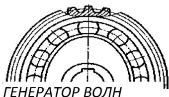
Представляют собой цилиндрические передачи, где одно из колёс имеет гибкий венец. Этот гибкий венец деформируется генератором волн специальной некруглой формы и входит в зацепление с центральным колесом в двух зонах [17].
