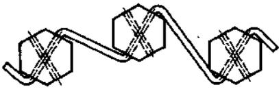
В групповых соединениях головки болтов обвязывают проволокой через отверстия с натяжением проволоки в сторону затяжки резьбы.
