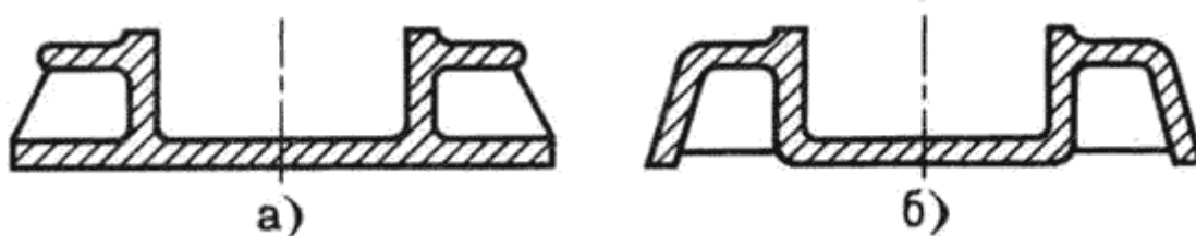
Рис.8.9. Устранение пазов в конструкции литой детали
