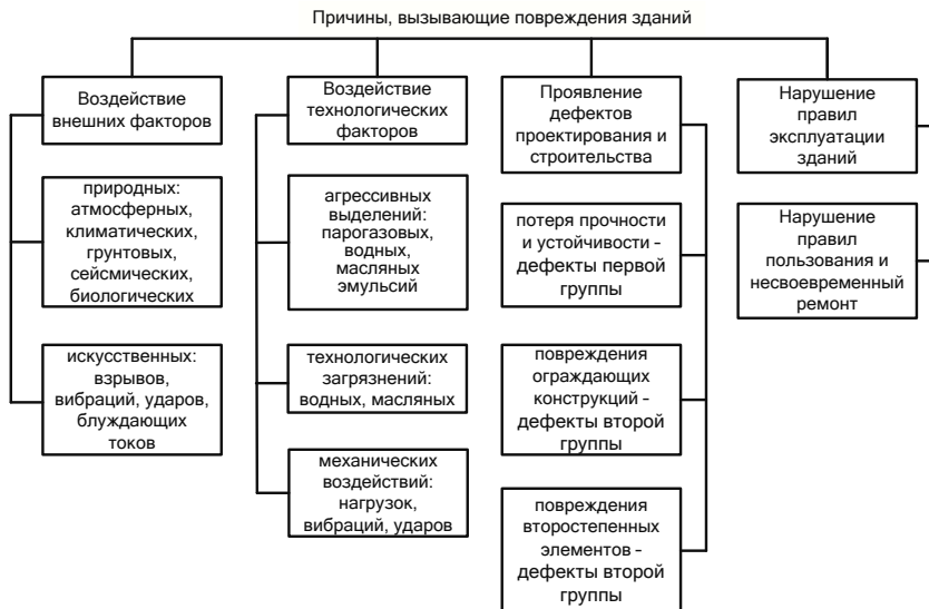
Рисунок 2.2 – Классификация повреждений зданий в процессе эксплуатации
