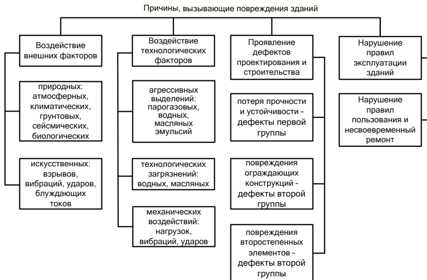
Рисунок 2.2 – Классификация повреждений зданий в процессе эксплуатации
