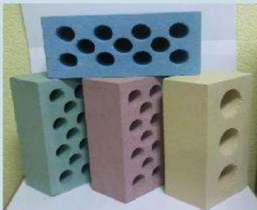
**Силикатный кирпич** применяется для возведения основных конструкций зданий и сооружений. Нельзя применять для кладки печей, труб и дымовых каналов. Используется в декоративных целях.
