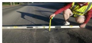
Рис. 1. – Схема измерения колеи рейкой
