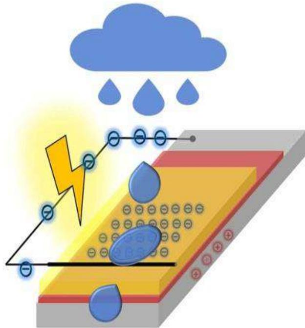
ТАКИМ ОБРАЗОМ КАПЛЯ ДОЖДЯ, ПОПАДАЯ НА НОВЫЙ ГЕНЕРАТОР, УДЕРЖИВАЕТСЯ НА НЕМ ЗА СЧЁТ ЭЛЕКТРОСМАЧИВАНИЯ. В ЭТО ЖЕ ВРЕМЯ ВНУТРИ ГЕНЕРАТОРА ПРОИСХОДИТ ПЕРЕРАСПРЕДЕЛЕНИЕ ЗАРЯДОВ.
