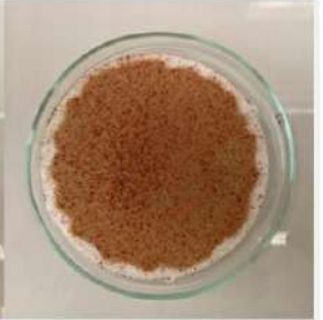
Osad w reaktorze (mieszanka bakterii deamonifikujących oraz nityfikantów)
