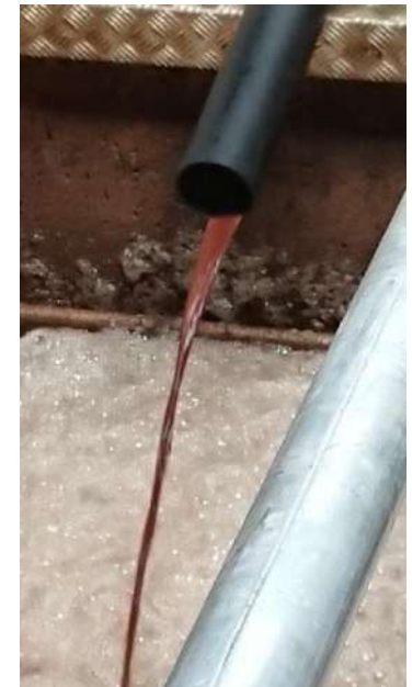
Osad w reaktorze (mieszanka bakterii deamonifikujących oraz nityfikantów)
