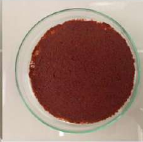
Odseparowane i zawrócone do reaktora granulki deamonifikujące
