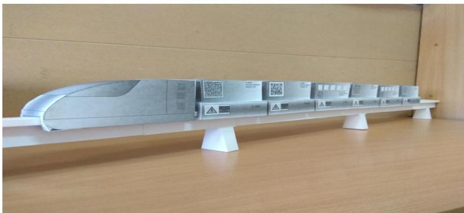
Снятые с состава боксы по конвейерной ленте отправятся на сортировочный пункт. Пассажирские боксы отправятся на вокзал, а грузовые после сортировки распределяться между получателями груза. Сама суть боксов в их универсальности. В один состав можно устанавливать как пассажирские, так и грузовые боксы. В современных поездах это невозможно по техническим причинам.
