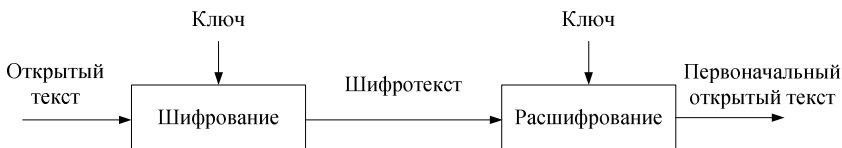
Рисунок 3 – Шифрование и расшифрование с одним ключом
