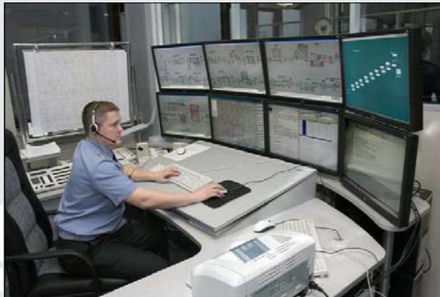
**Система ГИД «Неман»** используется для автоматизации построения графика исполненного движения на участках железной дороги, оборудованных системами диспетчерской централизации, и является элементом информационно-управляющей системы по организации перевозочного процесса, функционирующей в круглосуточном режиме. Технические средства ГИД обеспечивают отображение на мониторе исполненного, перспективного и планового графиков движения поездов.
