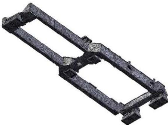
Рисунок 3 – Укрупненное изображение области рамы с примером построения сетки
