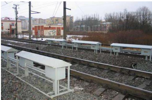
Рисунок 1 – Пост акустического контроля выявления дефектов поезда на ходу
