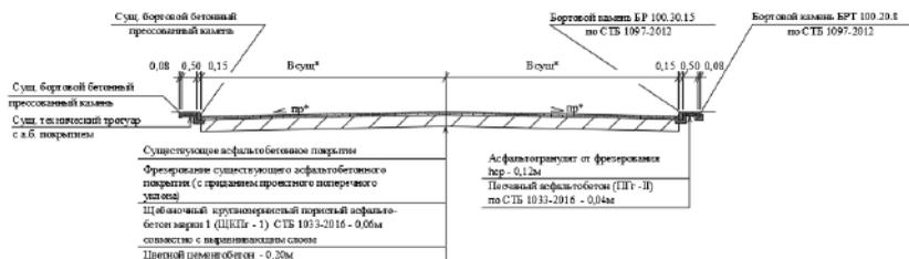
Рисунок 1 – Конструкция дорожной одежды с цементобетонным покрытием на ул. Мазурова
