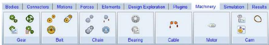
Рисунок 1 – Инструменты MSC.Adams для создания механических передач
