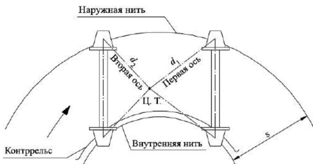
Рисунок 1 – Схема двухосного экипажа при вписывании в кривую малого радиуса
