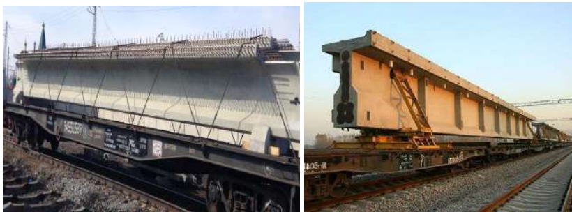
Рисунок 1 – Размещение длинномерных грузов на вагонах и их сцепах
