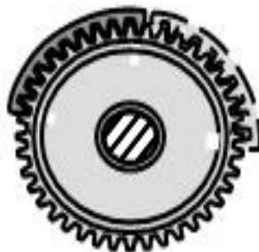
Рисунок 4 – Нанесение магнитной суспензии при проведении МПК зубчатых колёс дефектоскопом УМДЗ
