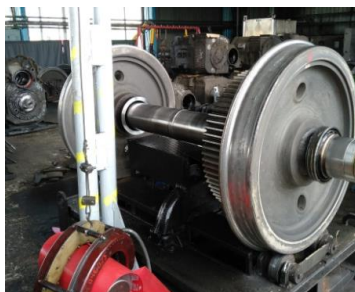
Рисунок 4 – Нанесение магнитной суспензии при проведении МПК зубчатых колёс дефектоскопом УМДЗ
