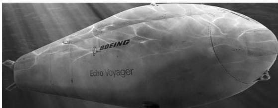
Рисунок 2 – Подводный дрон EchoVoyager фирмы Boeing
