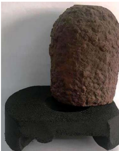
Рисунок 1 – Общий вид экзотермических вставок с фасонным стержнем
