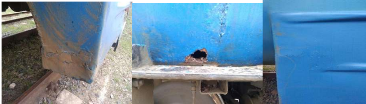
Рисунок 2 – Характерные неисправности кузова дизель-поезда типа ДРБ1
