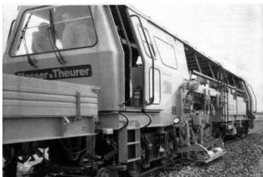
Рисунок 1 – Выправочно-подбивочно-рихтовочная машина ВПР–08 (а), подбивочный блок (б)
