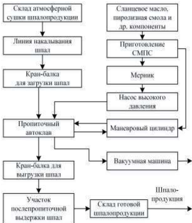
Рисунок 3. Технологическая схема пропитки деревянных шпал эмульсионным защитным средством СМПС
