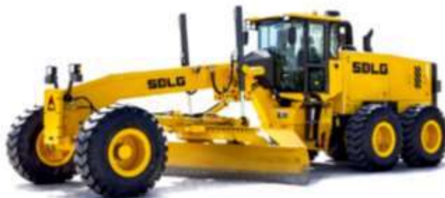
Рисунок 5 – Общий вид автогрейдера SDLG G9290
