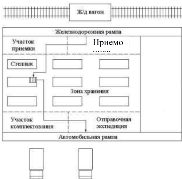
Рисунок 1 – Схема размещения технологических зон склада
