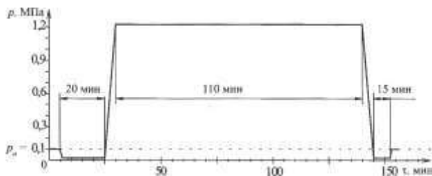
Рисунок 2. Режим пропитки древесины защитным средством СМПС
