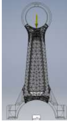
Рисунок 2 – Фантом изделия с рассчитанным каркасом
