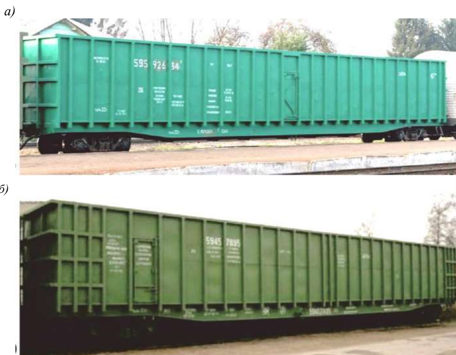
Рисунок 1 – Конструктивное отличие вагонов модели 23-4000-01 и модели 23-4000-02
