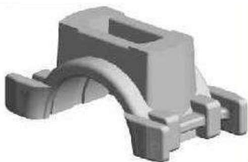
Рисунок 1 – Конструктивное исполнение адаптера (а) и его расположение в колесной паре (б)
