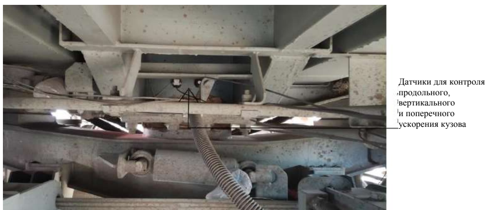
Рисунок 2 – Датчики для контроля продольного, вертикального и поперечного ускорения кузова
