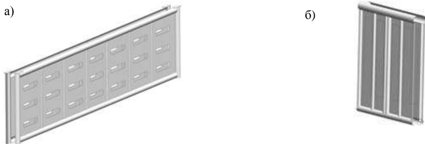
Рисунок 2 – Составляющие несущей конструкции полувагона из сочлененных оболочек: а – стена боковая; б – стена торцевая
