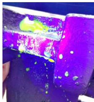
Рисунок 3 – Пример выявления искусственного (а) и эксплуатационного (б) дефектов
