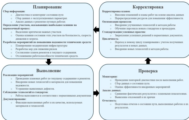
Рисунок 2 – Схема управления техническим состоянием железнодорожного пути
