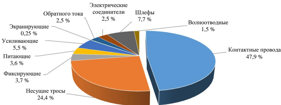
Рисунок 2 – Распределение повреждений проводов и тросов контактной сети
