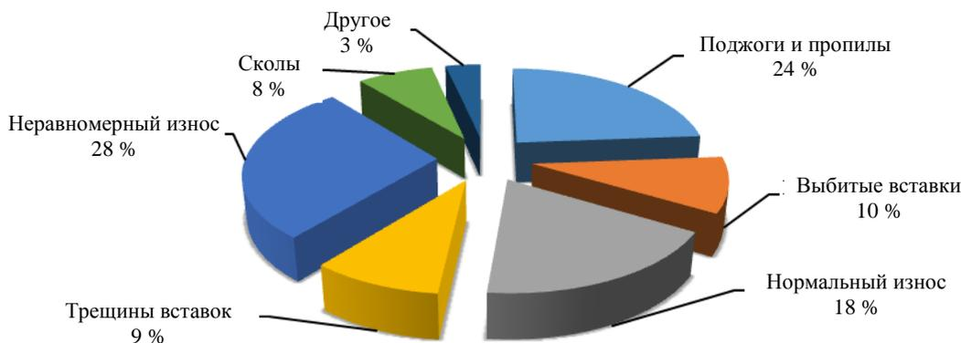
Рисунок 3 – Распределение неисправностей полозов токоприемников
