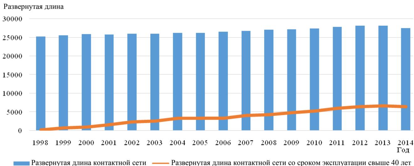
Рисунок 1 – Динамика изменения развернутой длины контактной сети
