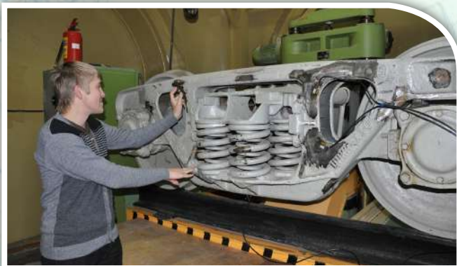
Изучение устройства и испытания грузовой тележки
