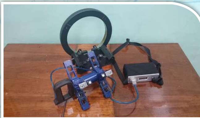
Прибор для измерения параметров буксы «РОБОКОН»
