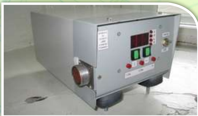
Устройство скоростного регулирования тормозных нажатий ОНИЛ «ТСПС»
