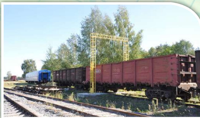
Стенд проверки габарита подвижного состава и вагон-лаборатория (на заднем плане)
